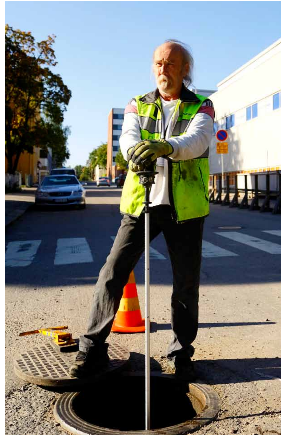
▲ Putkiston syvyys mitataan laskemalla prisma-sauva kaivon pohjalle, tästä takymetri mittaa lukeman. Kuvassa Aimo Virtanen.
